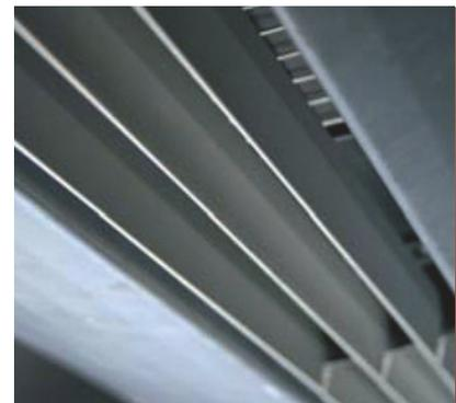
durch optimale Einstellung der richtbaren Auspufflamellen werden maximale Energieersparnisse erzielt
