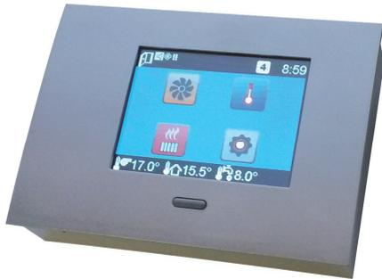
Die Steuerung ist zur Montage an der Wand, Schutzart IP 20, bestimmt. Der Anschluss der Steuerung erfolgt über ein Kabel mit angepresstem RJ-45-Stecker.
